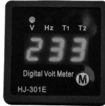
(V) – in diesem Modus wird der Generatorspannungspegel in Volt angezeigt
