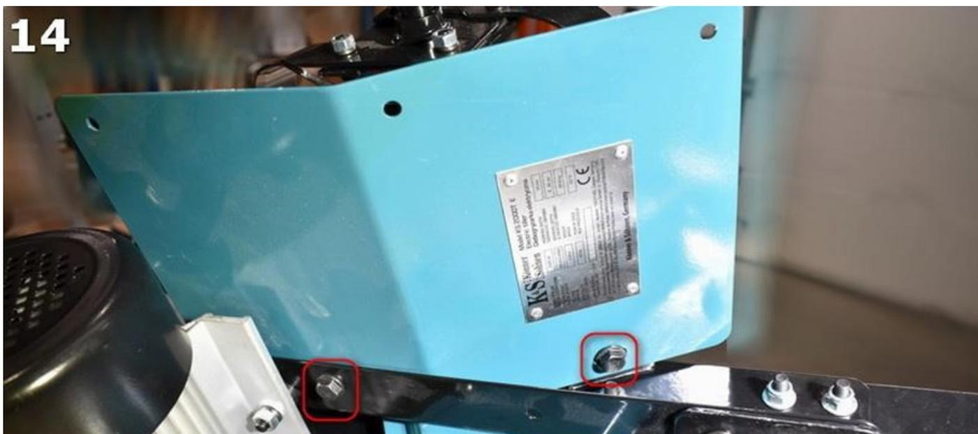
Mithilfe von zwei Bolzen stellen Sie die Konsole des Bedienfeldes ein, wie im Bild 15 gezeigt. Für die Benutzerfreundlichkeit ist eine 3-stellige Positionsregelung der Konsole vorgesehen.
