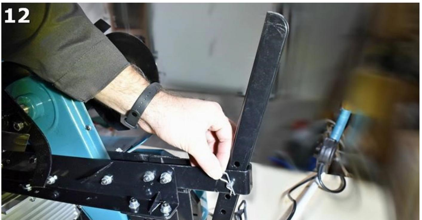
Installieren Sie den Schutzflügel an die Bodenhacke mit zwei Bolzen, wie im Bild 13 dargestellt.
