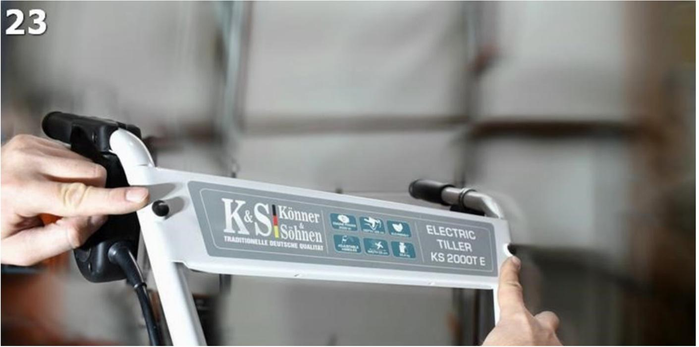
Um den Motor zu starten, stecken Sie den Stecker der Bodenhacke in eine Steckdose. Drücken Sie die blaue Taste und heben Sie den blauen Hebel an, während Sie ihn gedrückt halten, wie im Bild 24 gezeigt.
