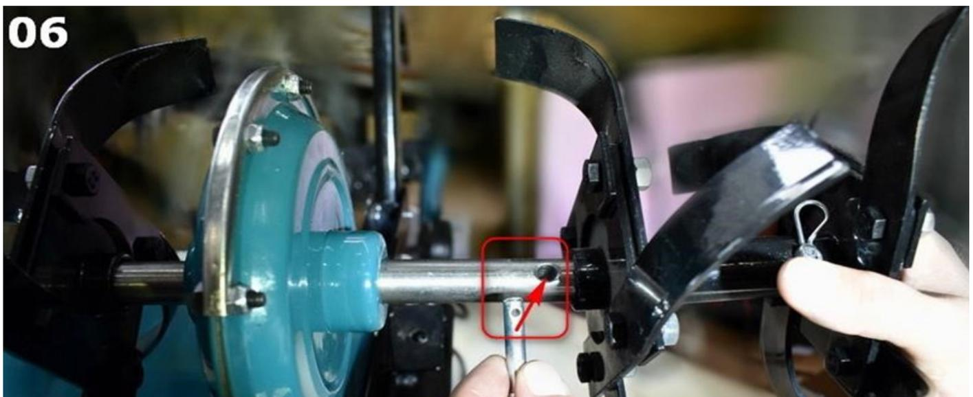
Stellen Sie den Sicherungsbolzen mit dem Klappstecker fest, wie im Bild 07 gezeigt.
