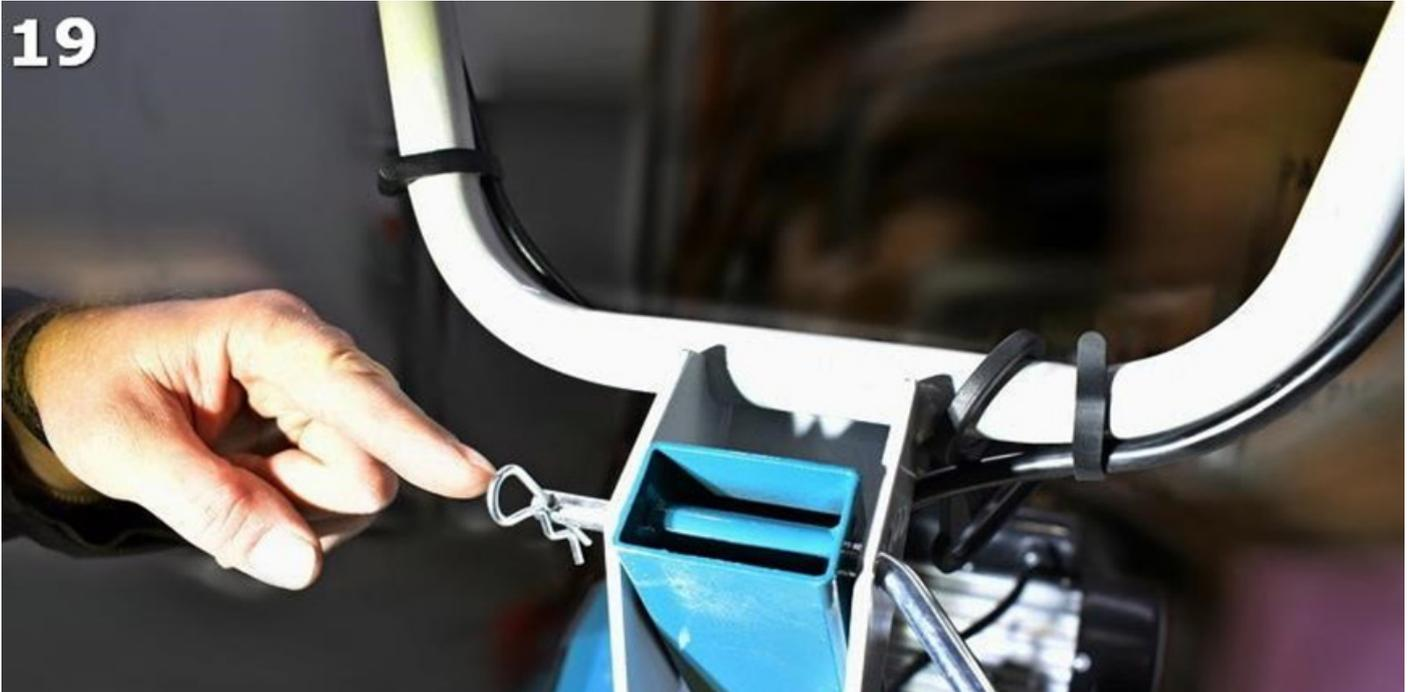
Fixieren Sie das Bedienfeld in unterer Lage mithilfe Bolzen, wie in den Bildern 20 und 22 gezeigt.
