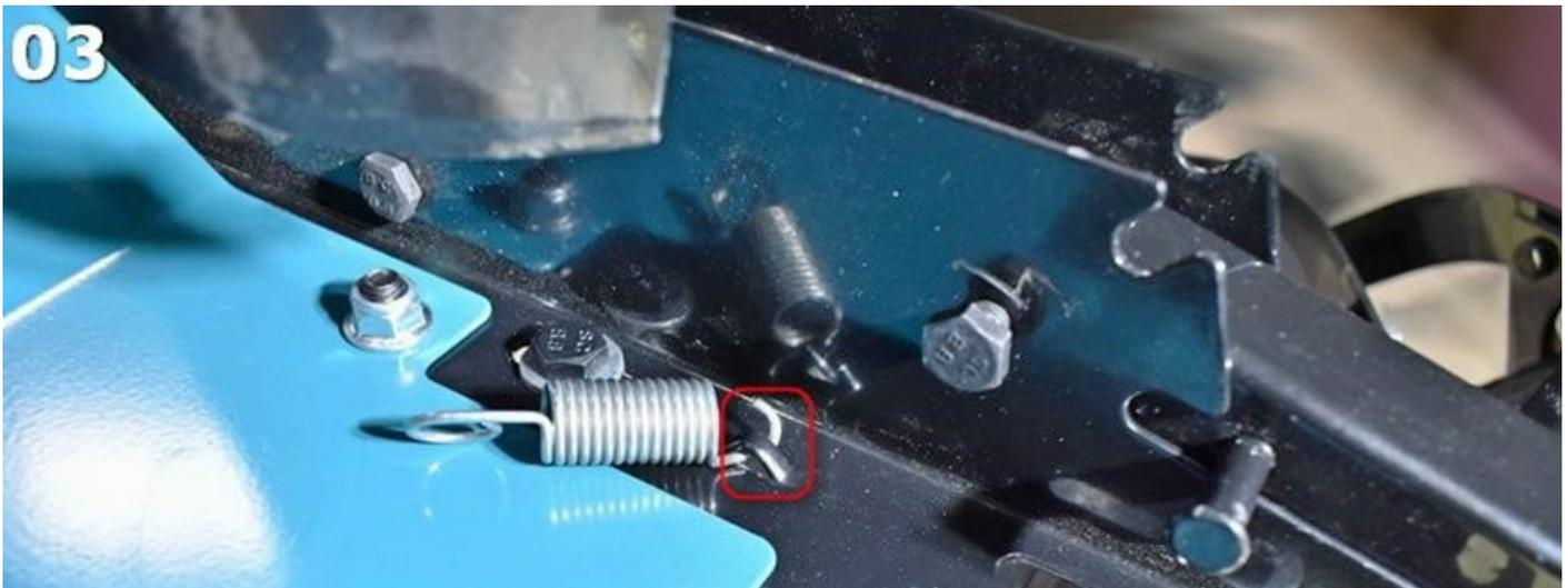
Das andere Federende wird mit einer Flachrundzange an die spezielle Halteschraube am Transportrad befestigt, genau wie im Bild 04 dargestellt.
