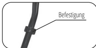
3. Befestigen Sie den Griff mit den Schrauben. Setzen Sie das Kabel am Griff wie gezeigt fest.
